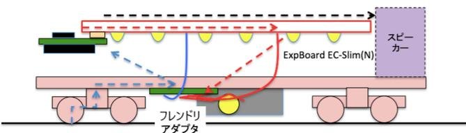
EC-Slimは、ESU社Locksound5-MicroなどのNEXT18コネクタを採用したDCCデコーダを、室内シースルーを確保しながらNゲージ電車・気動車にすっきり取り付けるためのアイテムです。室内灯ED内臓、モーター、ライト、サウンドデコーダへの配線をサポートします。KATO DCCフレンドリ動力車用アダプタも別基板で準備しています。
