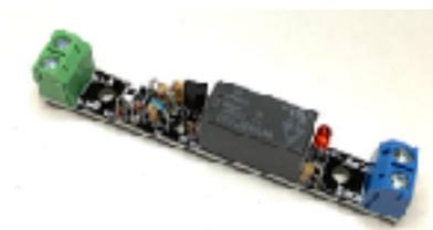
C1(電解コンデンサ) 以外の抵抗コンデンサを取り付けます。
