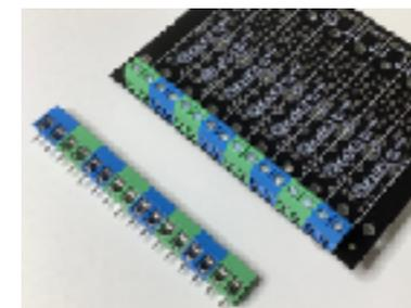
まずはリレー、端子台2つを基板から浮かないように半田付けしてください。端子は外側から配線する向きになります。なお、8CHを連結状態にする場合は半田付け前に端子同士を連結してください。
