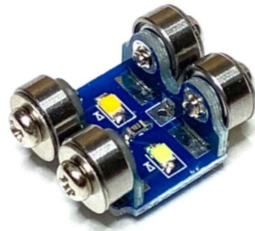
\*1 多くのボールベアリングは、通電することを前提としていません。電流を流すと、内部にスパーク跡がつき、徐々に性能が低下します。PitIn-Rではローラーの横腹に集電のためのワッシャーを取り付け内部ローラーの劣化を低減します。さらに、外側ネジ取り付けとして清掃や交換に対応します。
